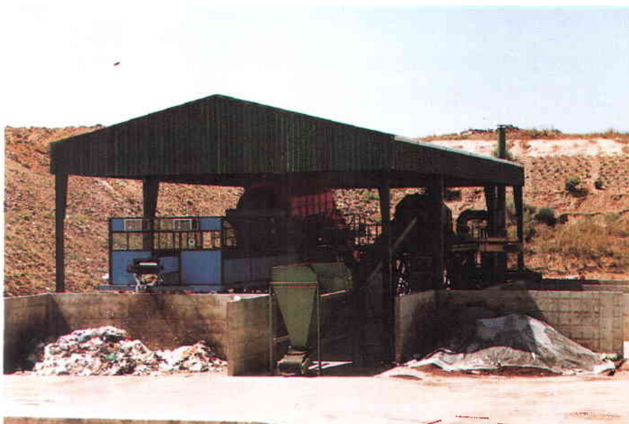
Los residuos orgánicos permiten obtener compost que, convenientemente depurado, se convierte en abono de buena calidad. En la imagen, planta piloto de reciclaje-compostaje.
